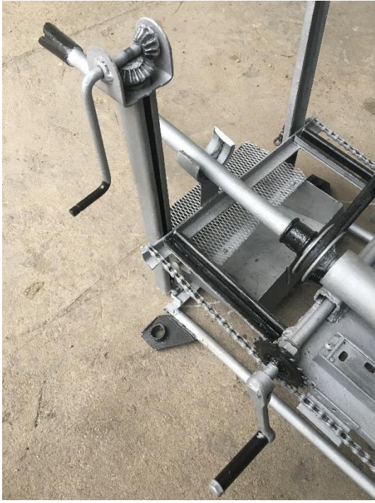
3.3 Сурет – Құбырды керекті дәрежеге орналастыру механизмдері
